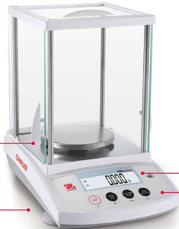
前置水平調節腳，方便用戶調節水平。
